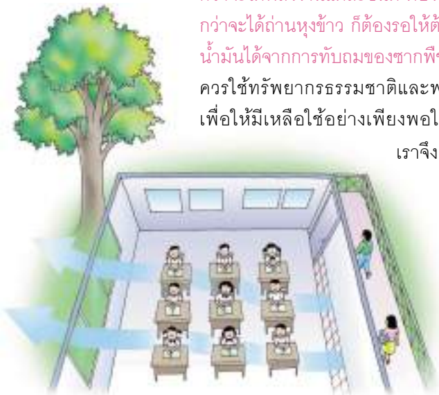
ทำช่องลมในทิศตรงกันข้าม เพื่อเปิดช่องทางให้ลมไหลเวียนเข้าในห้อง
