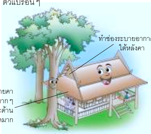
ลักษณะหลังคาที่ช่วยป้องกันความร้อนจากภายนอก
