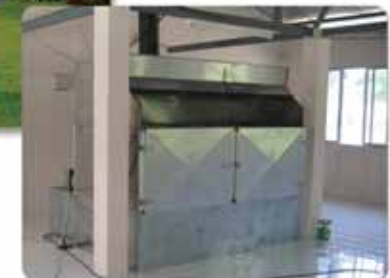
แบบใช้อากาศร้อนจากหลังคา
